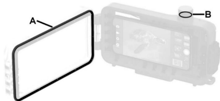
Retirer les joints toriques - Utiliser l'outil de retrait du joint torique pour le soulever et le retirer de la rainure.
